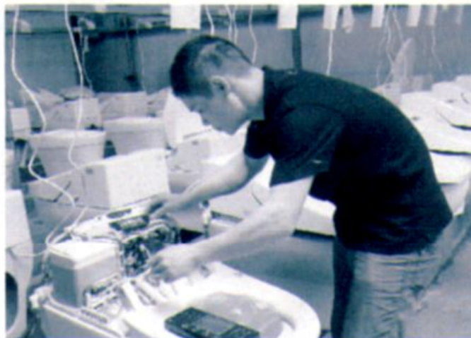
在老化试验车间,技术人员正在给智能马桶做检测。苏亦锋 摄
